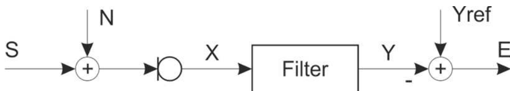
Abbildung 3.1: Schematische Übersicht des Wiener Filters
